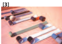
Abbildungen: [1], [2] Kältebruch bei Probestück; [3] Abrolllängen verschiedener Bahnen bei tiefen Temperaturen
