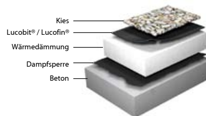
Dachaufbau mit Kiesauflast
