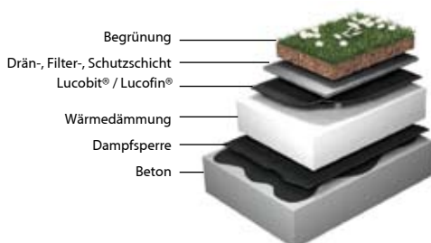
Dachaufbau mit Begrünung
